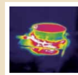
Тепловая эмиссия при нагреве на газовой плите (эффективность 57%)
