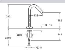
Спецификация продукта: Смеситель для раковины. E979-4. Коллекция: STILLNESS. BEC: 1,4 кг. ТИП УСТАНОВКИ: 1 отверстие. ТИП: Однорычажный. РАСХОД ВОДЫ: 6 л/мин при давлении 3 бар. ВЫСОТА ПОД ИЗЛИВОМ: 162 мм. РАССТОЯНИЕ МЕЖДУ ЦЕНТРОМ ИЗЛИВА И ЦЕНТРАЛЬНОЙ ОСЬЮ КОРПУСА: 132 мм. ПОДКЛЮЧЕНИЕ: С гибкой подводкой. МЕХАНИЗМ: Последовательный керамический картридж. СЛИВ: Без донного клапана. ОДНОРЫЧАЖНЫЙ СМЕСИТЕЛЬ: О. УСТАНОВКА: 1 отверстие. ГАРАНТИЯ НА ОТДЕЛКУ: 10 лет. Аэратор с антиизвестковым покрытием.
