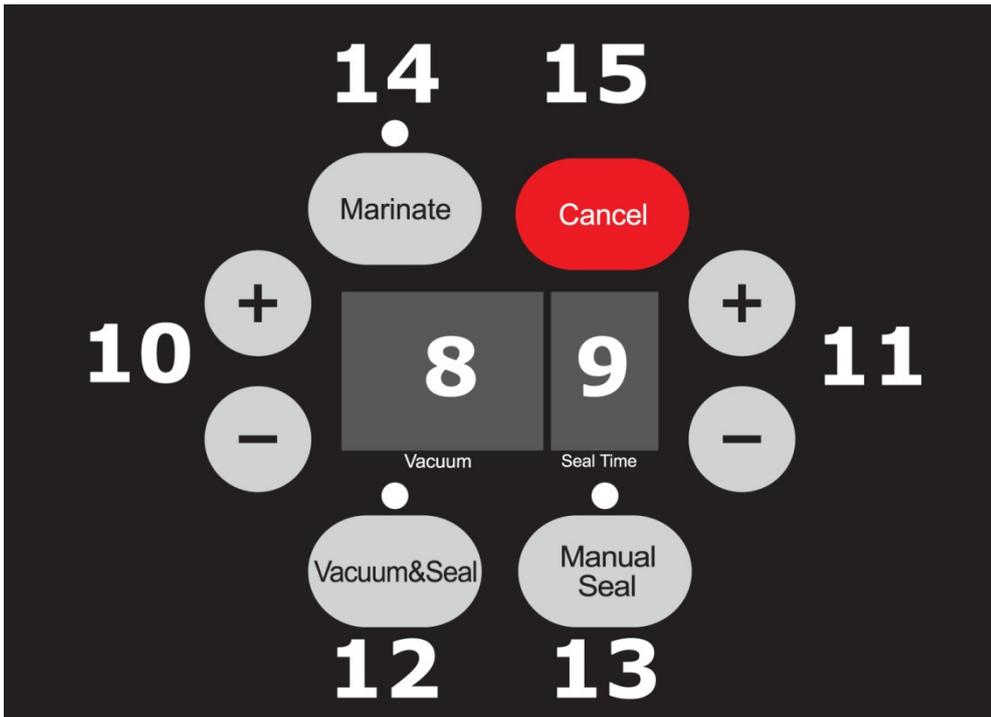
8 Anzeige Vakuumierzeit (Vacuum Time): numerische Anzeige mit zwei Funktionen
