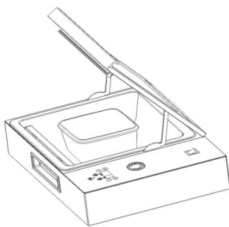
Placez les aliments à mariner dans le récipient de mise sous vide. Relevez la poignée. Ouvrez le couvercle de l'appareil et posez le récipient sans couvercle dans le compartiment de mise sous vide.
