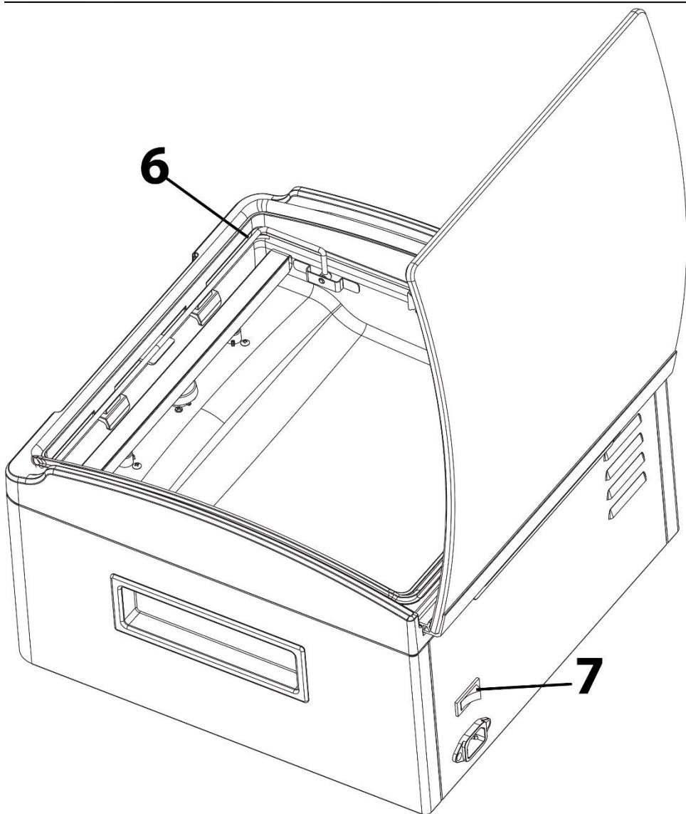
**6 Fijación:** Para fijar la bolsa durante el proceso de envasado al vacío. Levantar y plegar hacia abajo para fijar la bolsa.
