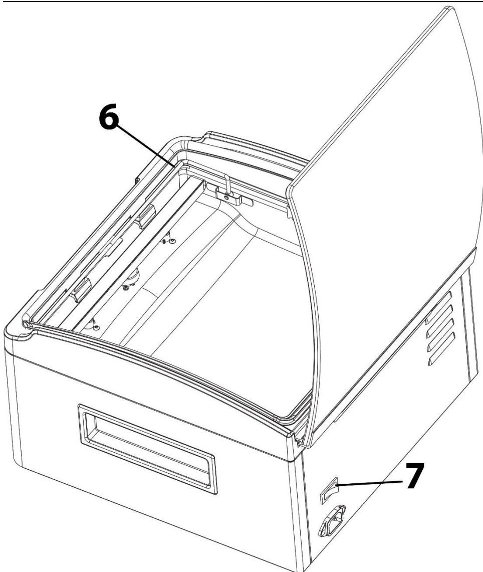
**6 Fissaggio:** Per il fissaggio dei sacchetti durante il processo di sotto vuoto e la saldatura. Sollevare e per il fissaggio, piegare il sacchetto in basso.
