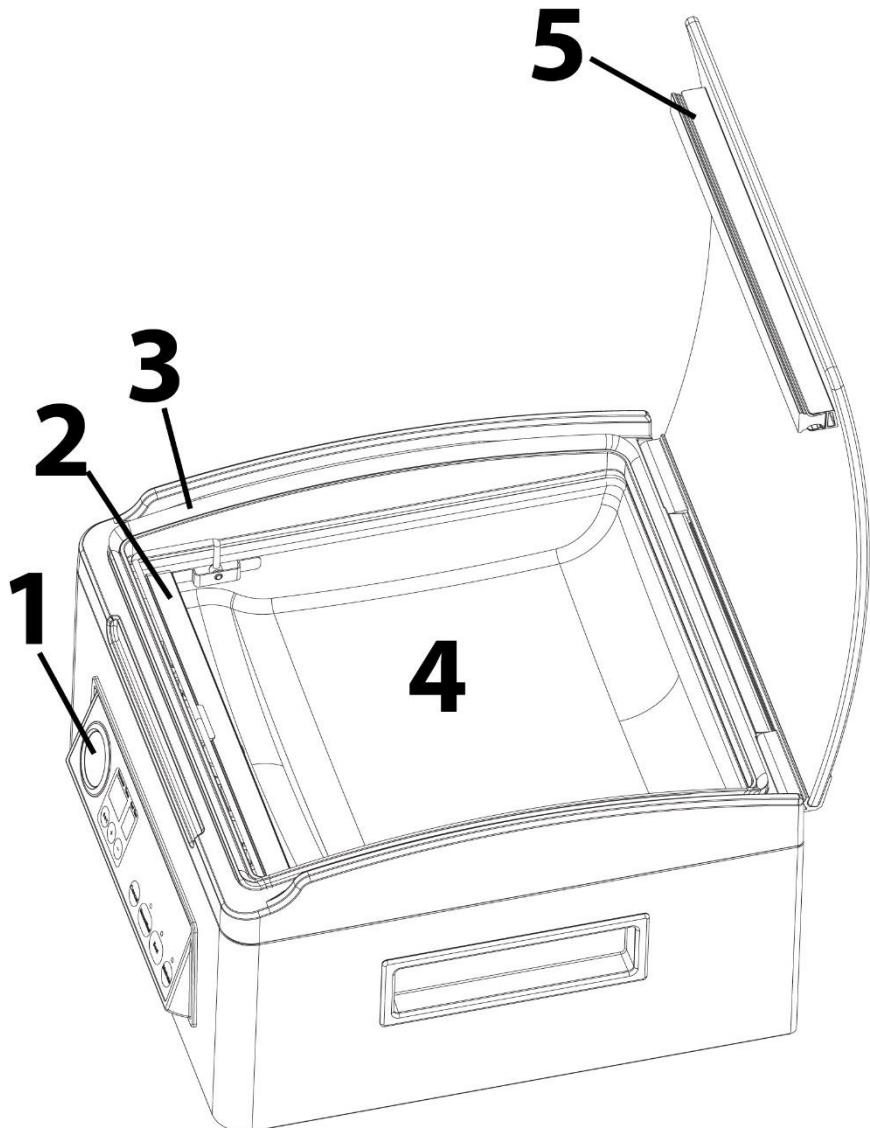
**1 Indicateur de dépression:** Indique le niveau de dépression dans le compartiment
