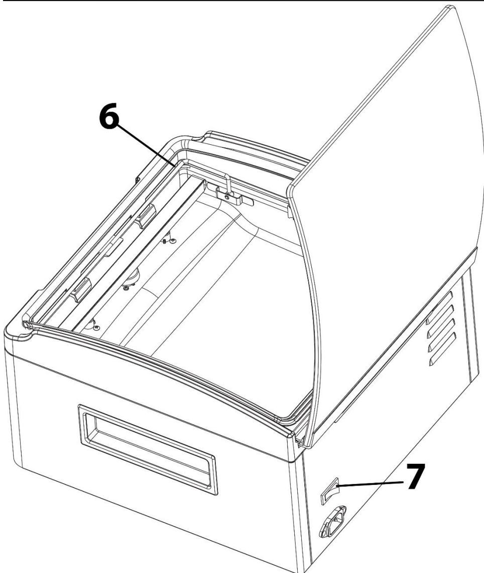
6 Fixierung: Zur Fixierung der Beutel während Vakuum- und Schweißvorgang. Anheben und zur Fixierung des Beutel nach unten klappen.
