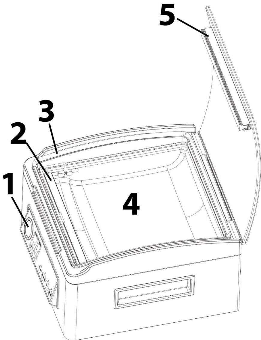
1 Unterdruckanzeige: Zeigt das Unterdruckniveau in der Kammer an
