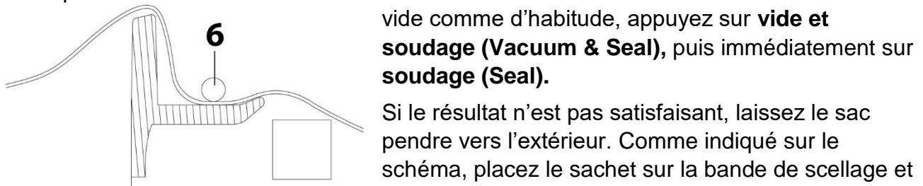
Si le résultat n'est pas satisfaisant, laissez le sac pendre vers l'extérieur. Comme indiqué sur le schéma, placez le sachet sur la bande de scellage et serrez-le sous la fixation (6).
