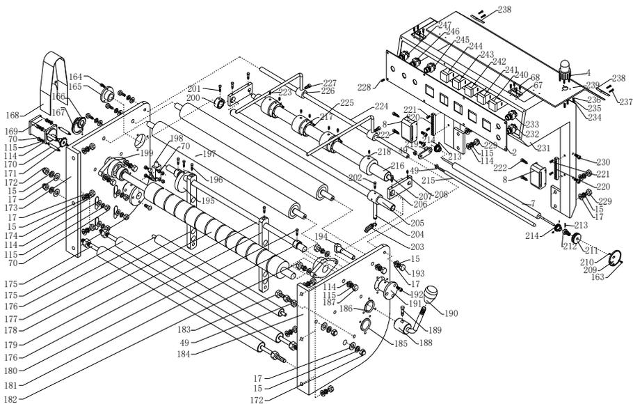
Рис. 3 – Устройство подачи плёнки
