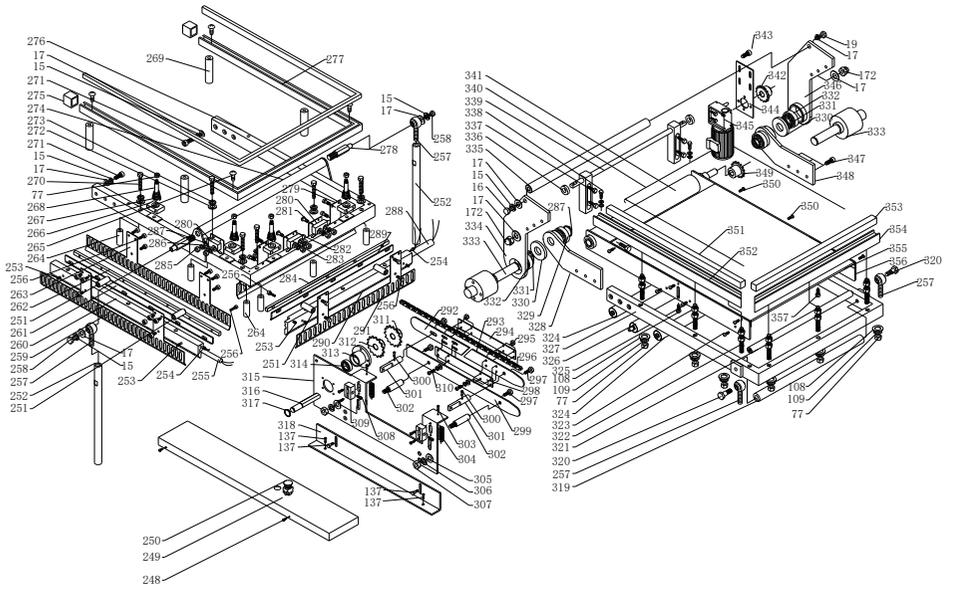
Рис. 4 – Устройство уплотнения и транспортировки пленки
