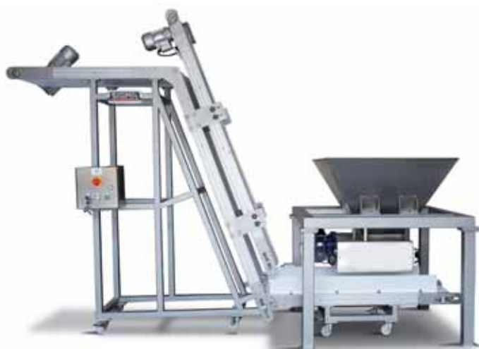
Tramoggia bassa con tappeto di trasporto Feeding hopper with conveyor belt
