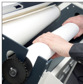
Формовочная лента Сверхбыстрая смена лент без демонтажа машины.
