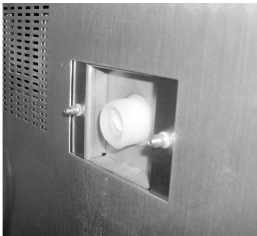
Рисунок 38 — водорозетка электроклапана для подключения к водопроводной сети.
